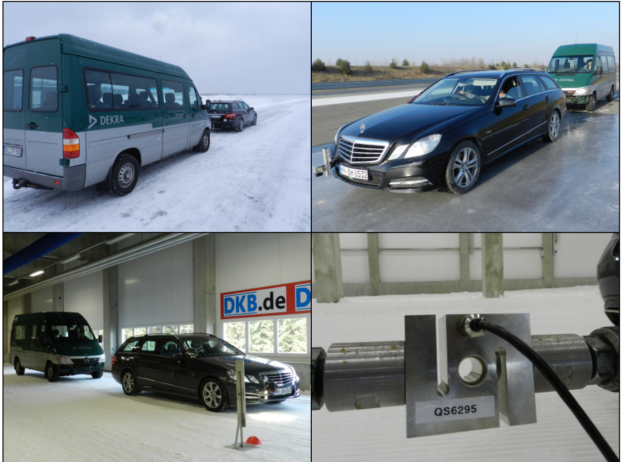
Bild 1: Zugkraftmessungen mit Schleppfahrzeug
