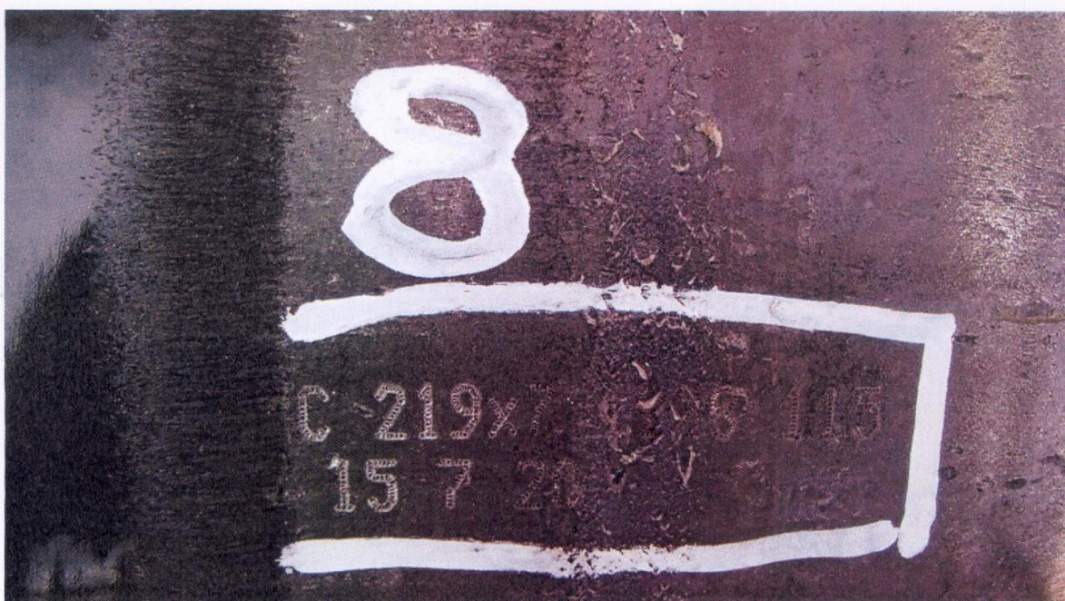
3.4 Сила удара на маркираторе установлена на 9:
