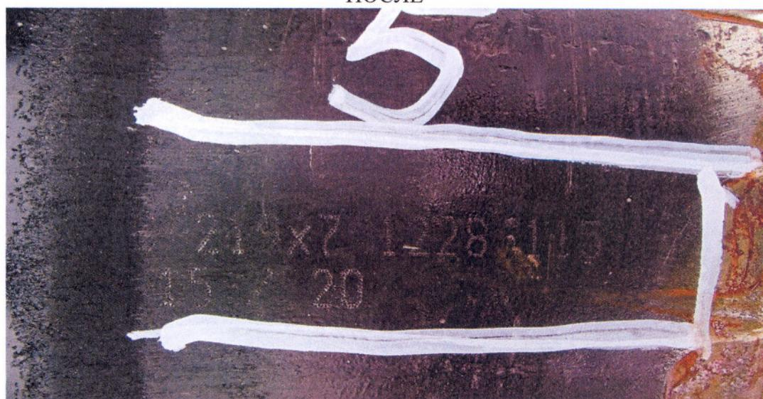
3.2 Сила удара на маркираторе установлена на 6:
