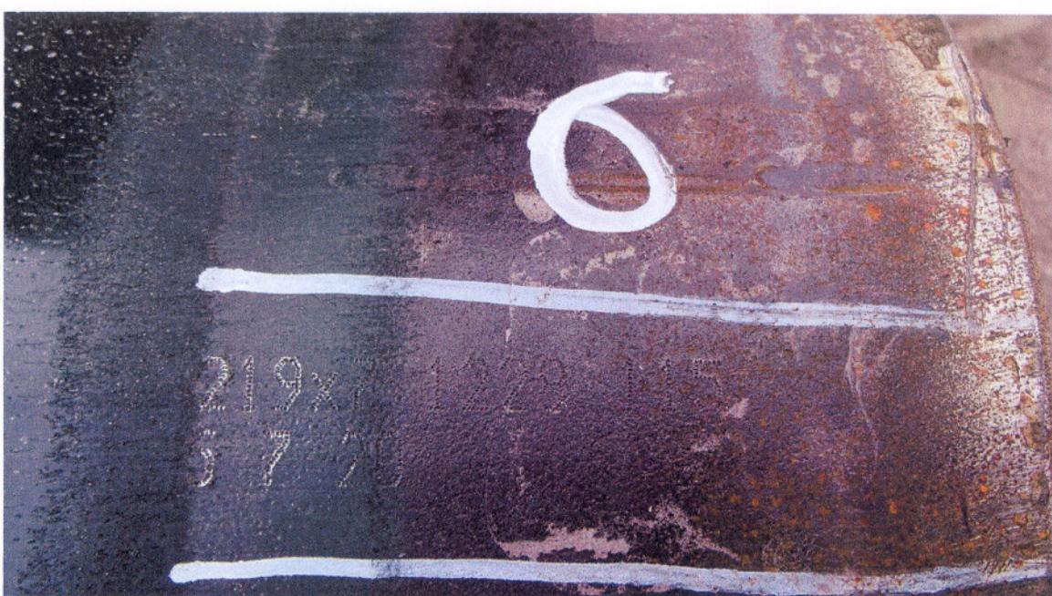
3.3 Сила удара на маркираторе установлена на 8:
