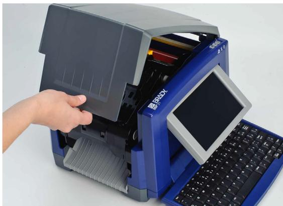
2. Освободите фиксатор на крышке риббона [2] и откиньте крышку.
