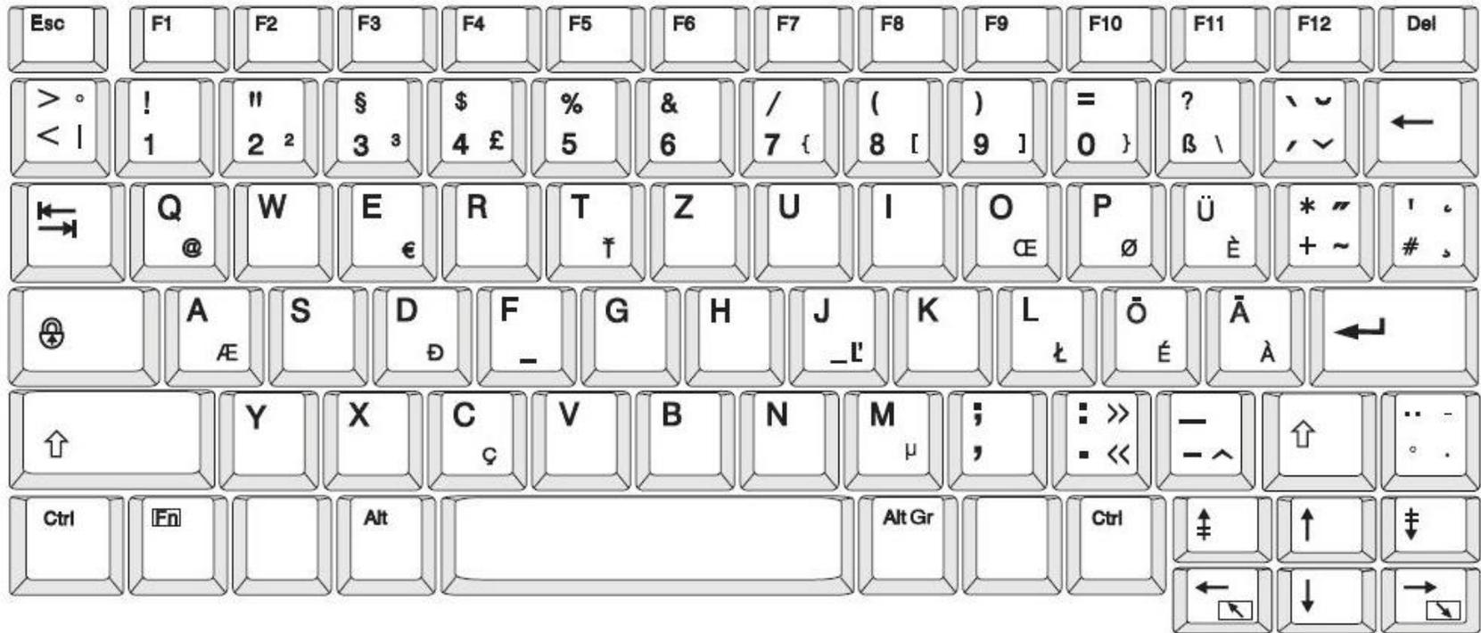
Figure 6. QWERTZ - конфигурация клавиатуры EC
