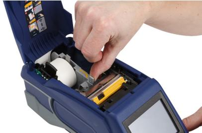
6. Убедитесь в том, что головка принтера заблокирована. Проверьте фиксирующий рычаг и убедитесь, что он направлен в сторону передней панели принтера.
