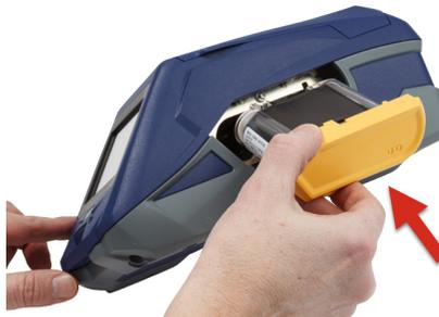
4. Поверните фиксирующий рычаг в направлении передней панели принтера, чтобы заблокировать его.
