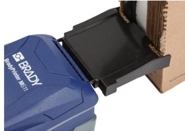
5. Вставьте катушку этикеток в принтер так, чтобы блок smart-cell был совмещен со считывателем и гнездом для материала этикеток. Отрегулируйте направляющую материала этикеток по необходимости.
