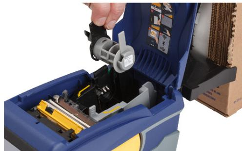
6. Потяните за свободный конец объемного материала этикеток, вытягивая его из коробки, и направьте по тракту в паз подачи объемного материала этикеток.
