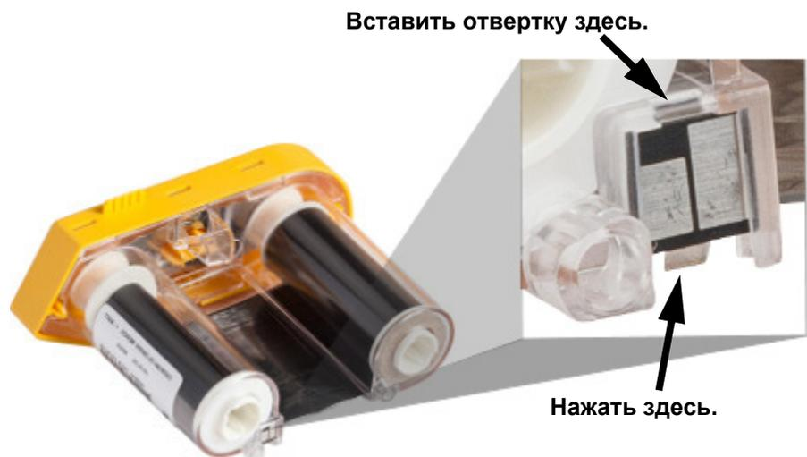
2. Повернув картридж желтой крышкой вверх, поочередно вставьте лезвие отвертки в каждое из 5 отверстий защелок, чтобы отжать фиксаторы. Отжимая фиксаторы отверткой, постоянно надавливайте на выступ для пальцев, чтобы крышка не вернулась обратно. Освобожденная крышка риббона отделяется от остального узла.
