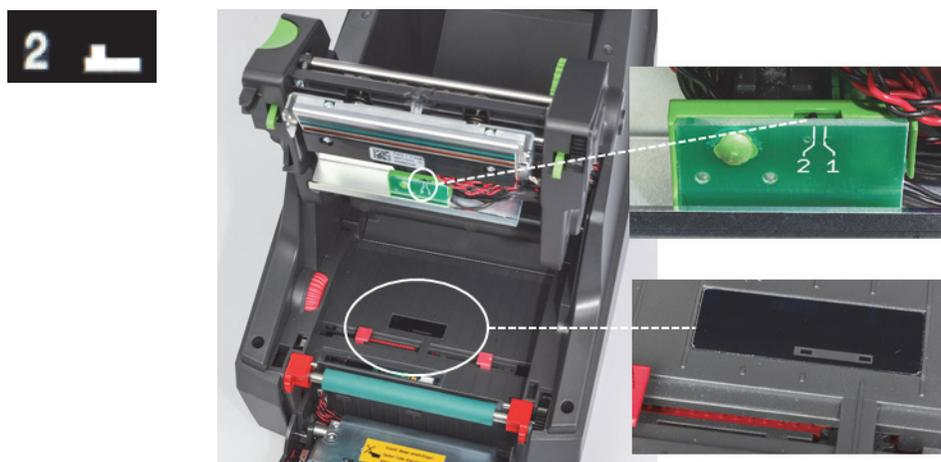
Узел датчика зазоров
