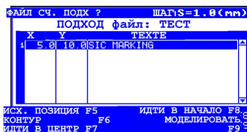
Использовать клавиши **+** (+) и **-** (-) для регулировки шага перемещения.
