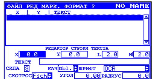
Поля X и Y соответствуют координатам маркировки (Y выравнивается по низу знаков)
