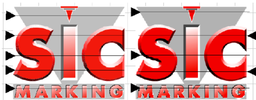
Рис. 4-57 Слева – однонаправленное сканирование; справа – двунаправленное сканирование
