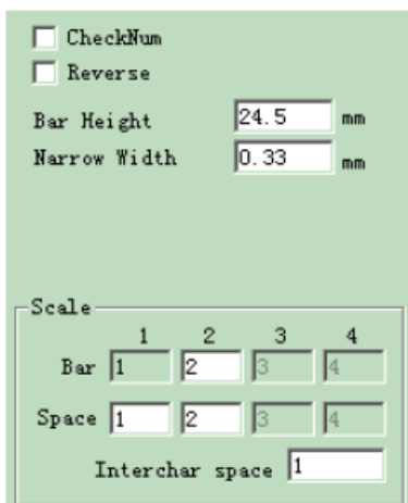
Рис. 4-16 Настройка параметров линейного штрих-кода
