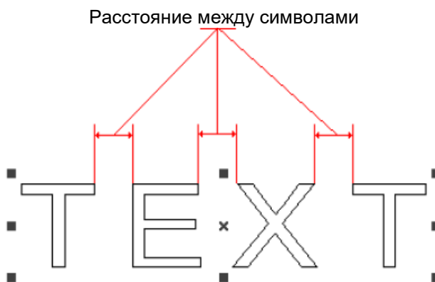
Рис. 4-30 Расчет расстояния согласно границам символов
