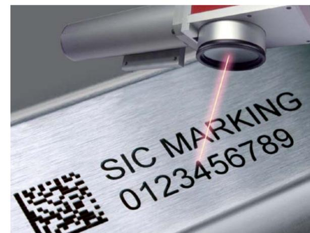
направляется на маркируемую поверхность. Лазерный луч создает любой необходимый маркировочный рисунок.
