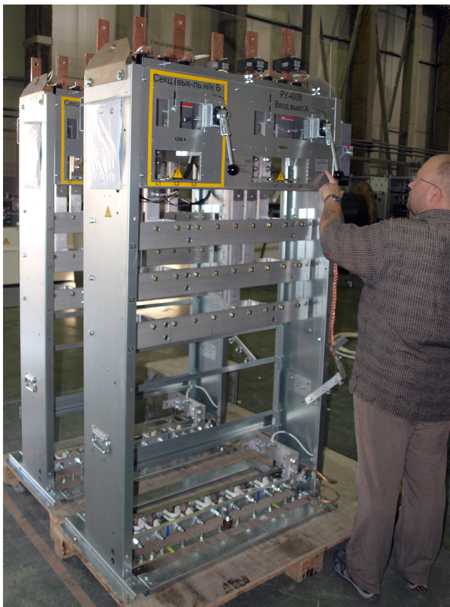
Рис. 1. Сборка электротехнического шкафа
