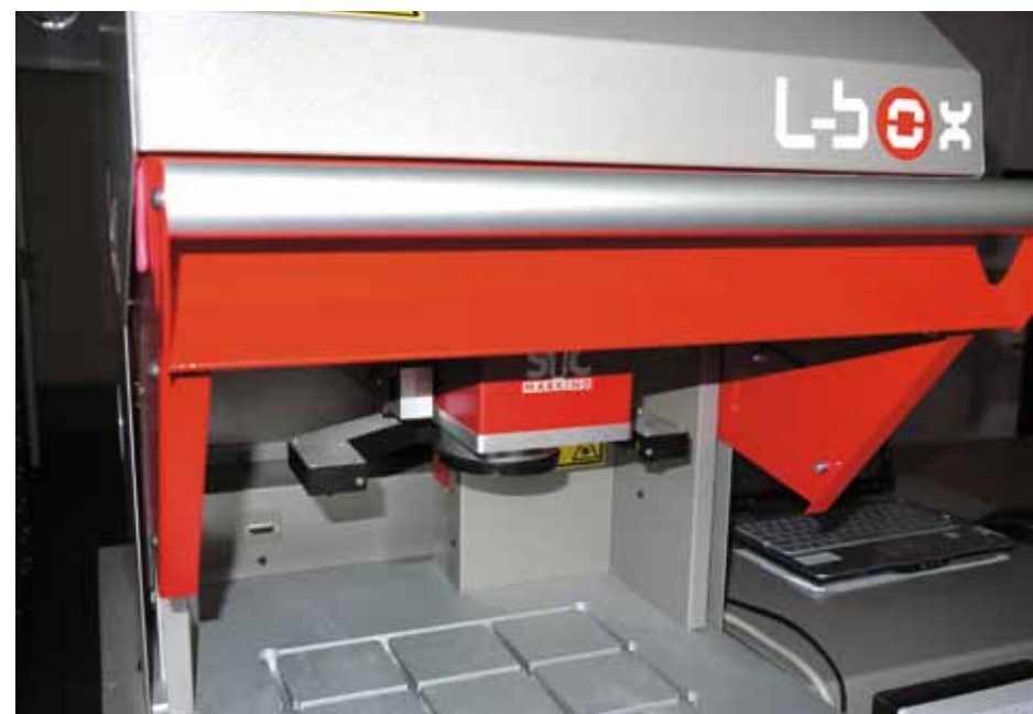
Рис 2в Операция №3 установка метки на дно отверстия
