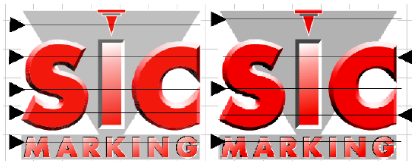
Рис. 4-57 Слева – однонаправленное сканирование; справа – двунаправленное сканирование
