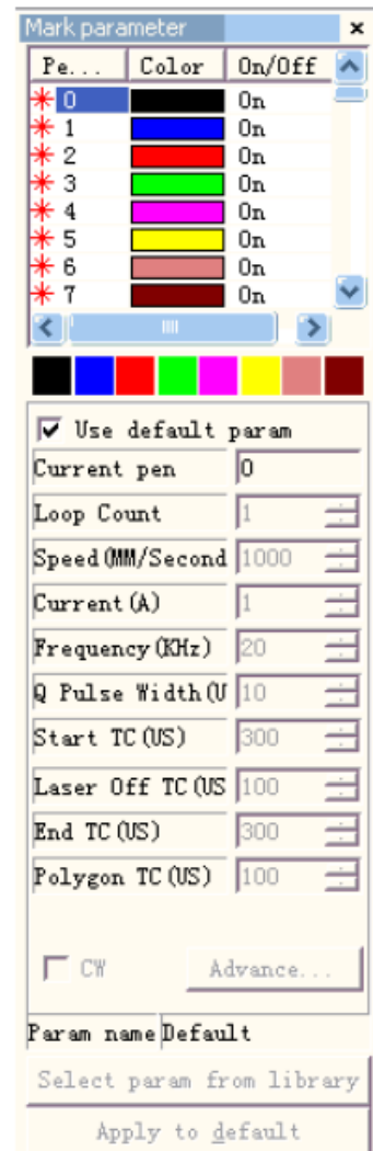
Рис. 10-2 Таблица параметров маркировки
