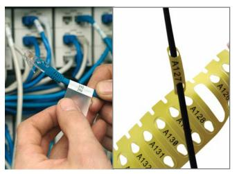
термоусаживаемая трубка, которая поставляется как в непрерывных рулонах, так и в вырубленных маркерах заданного размера различных цветов, на подложке. Данный тип маркировки используется на проводниках диметром от 0,5 мм до 24 мм. Использование термоусадочной трубки также решает задачи по бандажированию и электроизоляции. Кроме того Brady предлагает различные виды бирок для маркировки.
