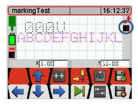
✓ Если объекты находятся вне окна маркировки, символ маркировки вне окна Будет отображаться в нижней левой части экрана. Ниже будет показан номер объекта ...
