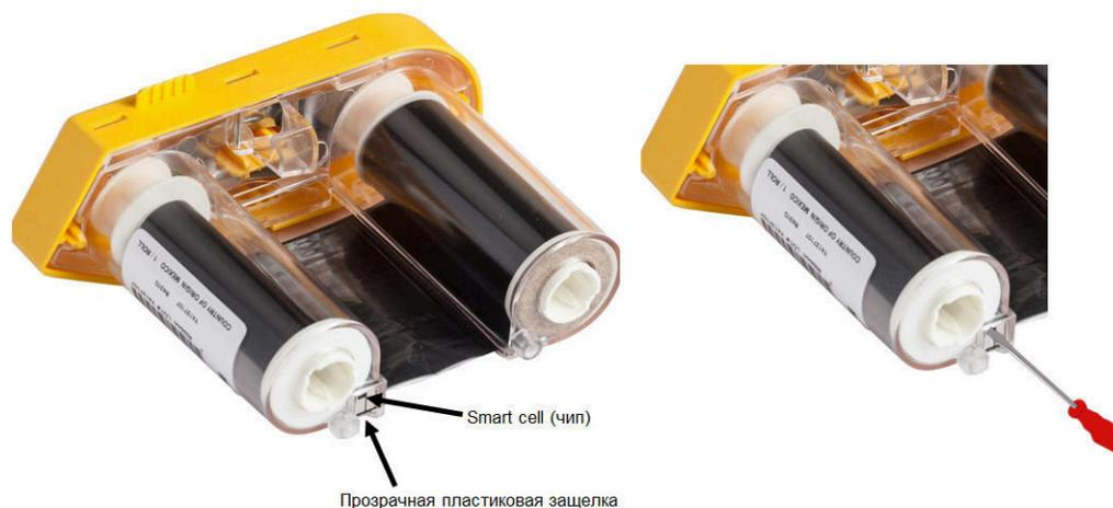
2. Повернув картридж желтой крышкой вверх, поочередно вставьте лезвие отвертки в каждое из 5 отверстий защелок, чтобы отжать фиксаторы. Отжимая фиксаторы отверткой, постоянно надавливайте на выступ для пальцев, чтобы крышка не вернулась обратно. Освобожденная крышка риббона отделяется от остального узла.
