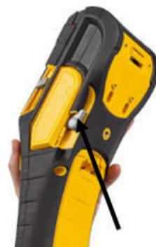
3. Если катушка этикеток не пуста, плавно перемотайте ее пальцем, чтобы вытянуть неиспользованный носитель из-под печатающей головки.
