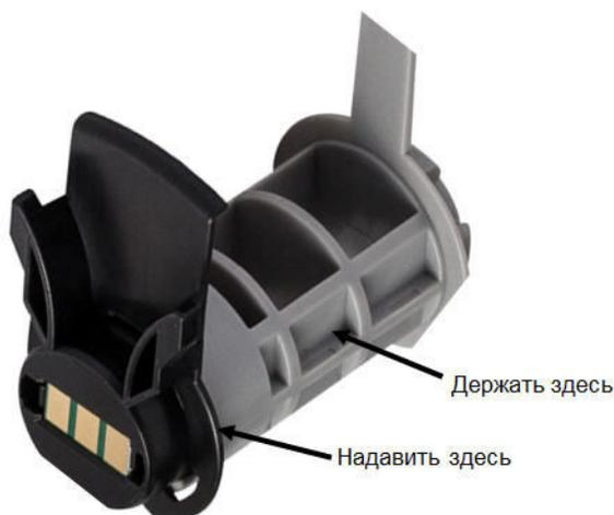
4. На обратной стороне черной заглушки нажмите лезвием отвертки на защелки в направлении изнутри наружу. Это позволит освободить блок smart-cell.
