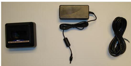
1. Вставьте круглый разъем кабеля блока питания в гнездо, расположенное на задней панели средства быстрой зарядки.
