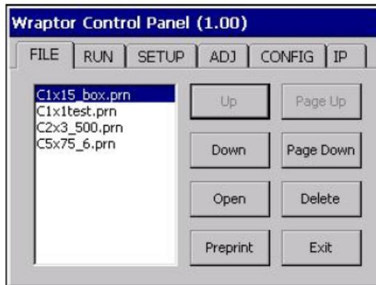
Рисунок 11. Панель управления принтера *Wraptor* на сенсорном экране
