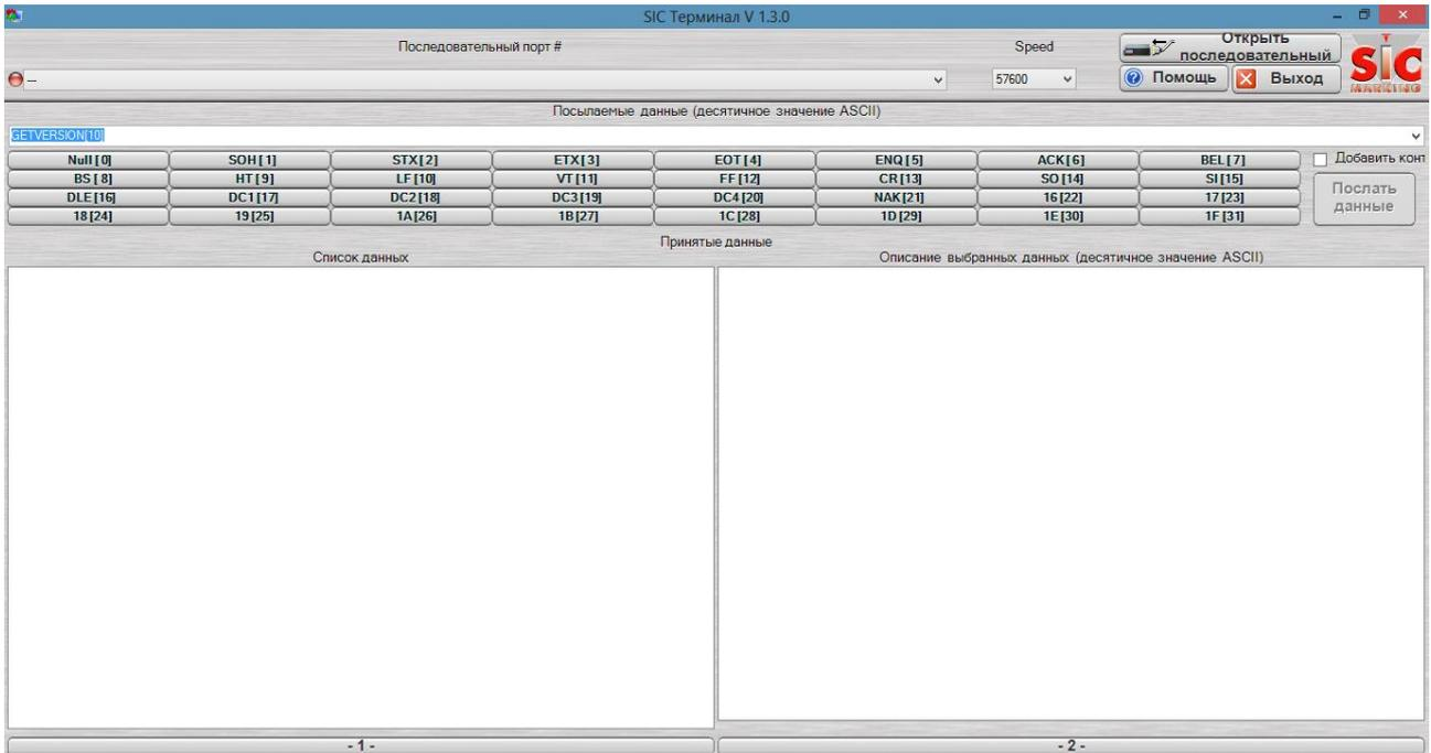
**SIC Terminal** применяется для проверки подключения контроллера к локальной компьютерной сети предприятия посредством USB, RS232 или Ethernet.
