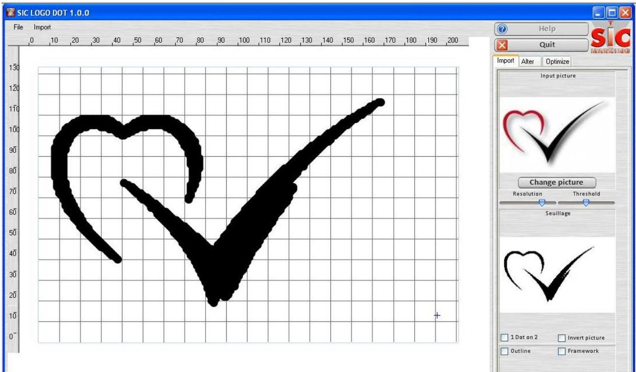
По завершению работы над логотипом в программе **SIC LogoDOT**, этот логотип возможно использовать для создания маркировочных файлов, вставив соответствующую строку в программе **SIC File Edit**. Также возможно использовать созданный логотип загрузив его непосредственно в контроллер с помощью программы **SIC File-Manager**.
