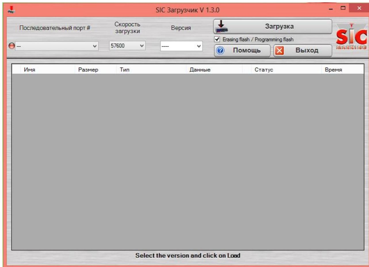
С помощью программы **SIC LOAD** в контроллер загружаются все необходимые для работы оборудования элементы (новые версии программного обеспечения, специально разработанные SIC Marking шрифты, инструменты поддержки языков, файлы конфигурации оборудования и др.).
