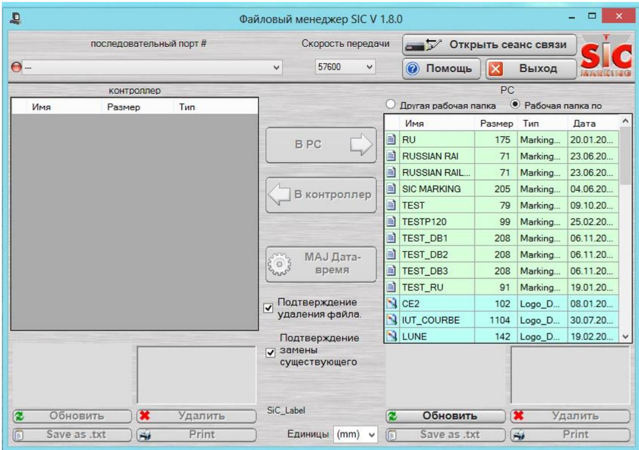
Сохранённый на персональном компьютере маркировочный файл возможно перенести на контроллер при помощи **SIC File-Manager**. Также, с помощью **SIC File-Manager**, можно удалить или распечатать маркировочный файл.
