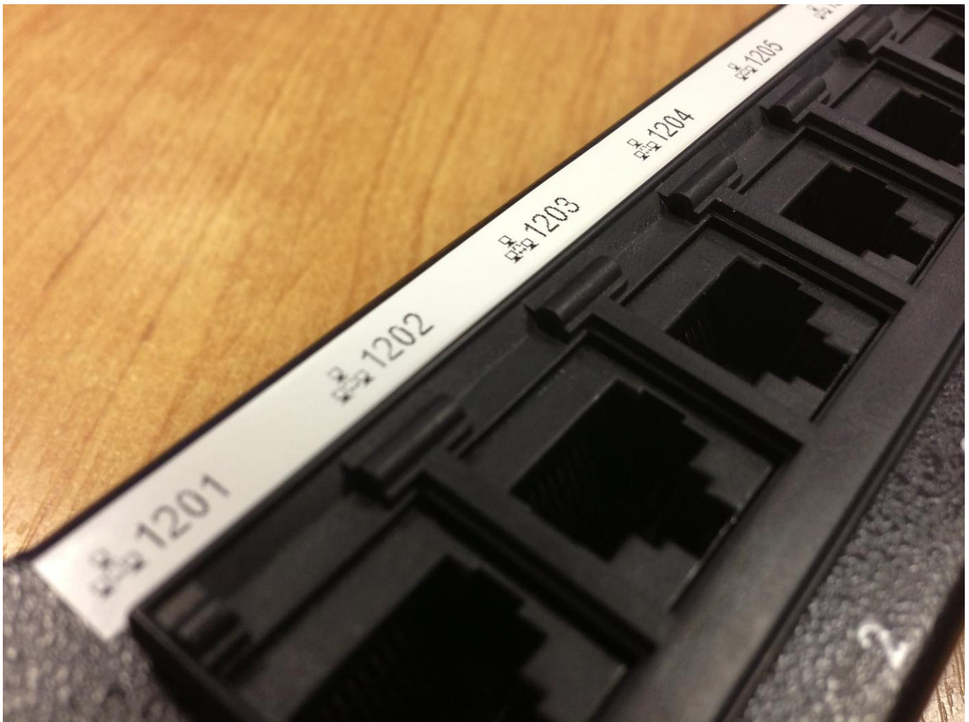
Рисунок 4. Пример последовательных идентификаторов на патч-панели
