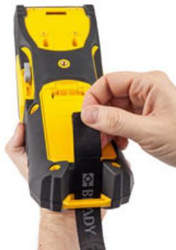
2. Не переворачивая принтер, пропустите ремешок под петлей в верхней части принтера, прямо в гнездо носителя.
