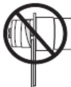
Данным инструментом нельзя выполнять отверстия одновременно в несколько слоев материала. Это может погнуть шпильку и повредить перфоформу, которая при разрушении может отскочить с большой скоростью и ранить.
