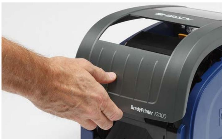
2. Откройте фиксатор на дверце печатающей головки [2] и откиньте крышку.
