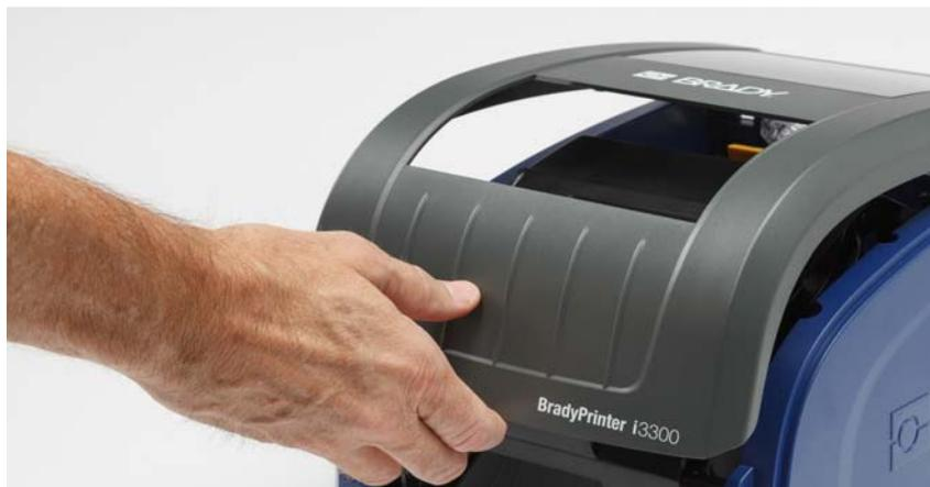
2. Откройте фиксатор на дверце печатающей головки [2] и откиньте крышку.
