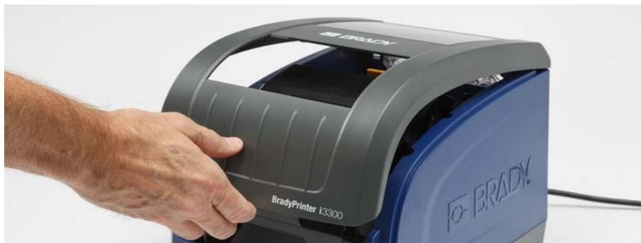
3. Откройте фиксатор на дверце печатающей головки [2] и откиньте крышку.
