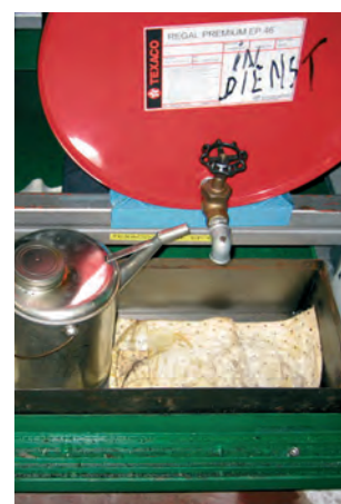
Салфетки OP разложены под резервуарами и масленками для сбора возможных маслопротечек.
