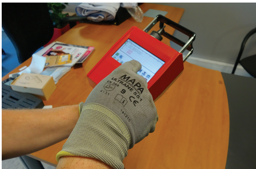
Рис. 2. Сенсорный экран маркиатора достаточно чувствителен, чтобы реагировать на нажатия пальцев рук в рабочих перчатках
